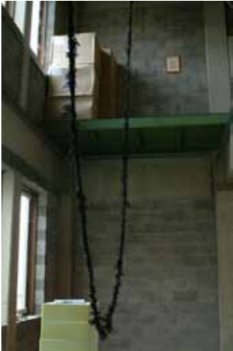
opgehangen mosseltouw in proefopstelling
