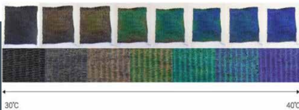
Thermochrome materialen veranderen van kleur onder invloed van de temperatuur
