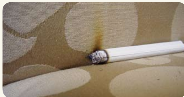
Ilustración 3: análisis de características de resistencia al fuego (test del cigarrillo)
