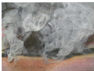
Brandtest met smeulende sigaret. Radiant panel test: meet de neiging tot vlamverspreiding - vloerbekleding.
