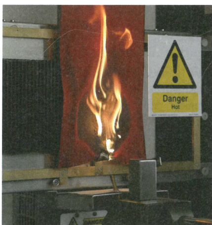
Flexiburn test voor de brandbaarheid van gordijnen.
