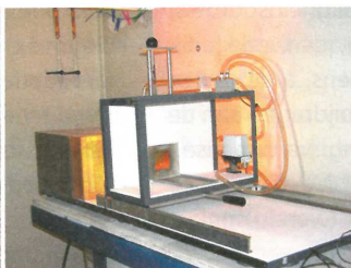
Brandtest met smeulende sigaret. Radiant panel test: meet de neiging tot vlamverspreiding - vloerbekleding.
