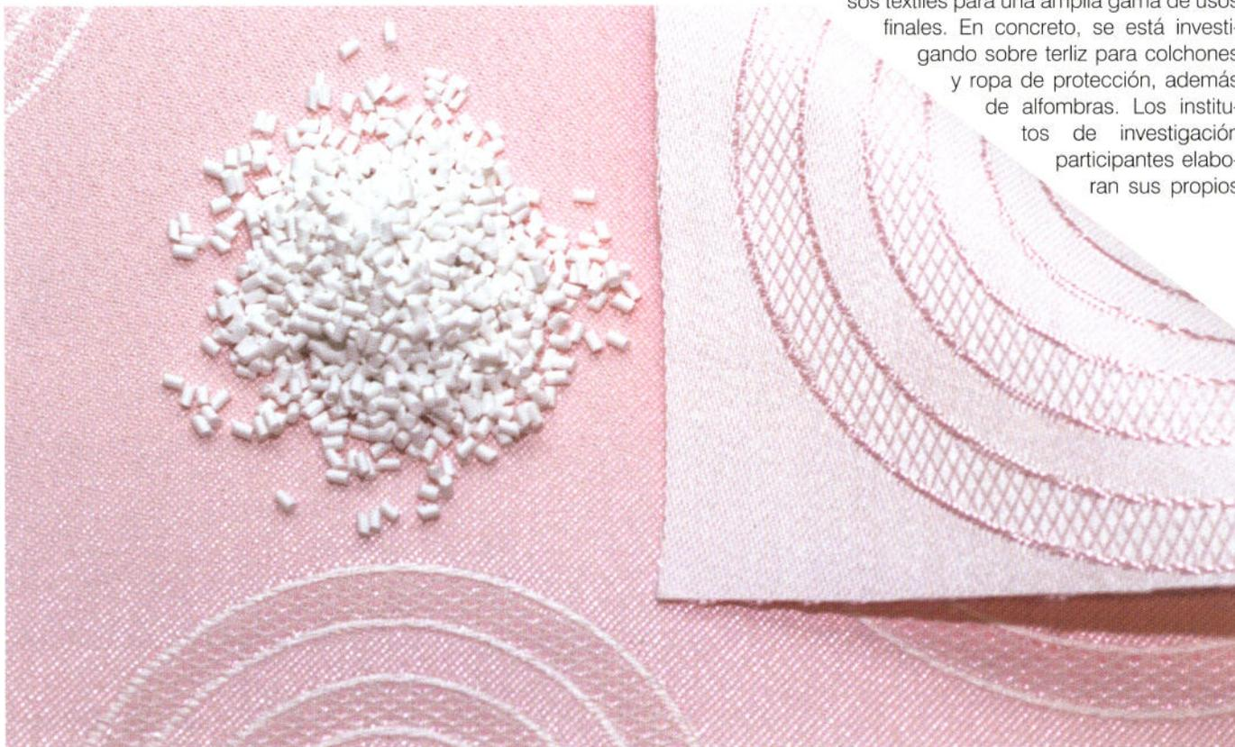
Figura1. Compuesto Hotmelt ignífugo (FR) + tejido para terliz de colchones recubierto con Hotmelt ignífugo.
