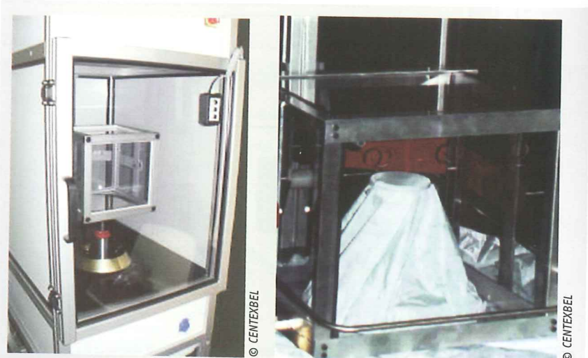
Caisson abaissé et piston levé définissant la zone d'échantillon testée
