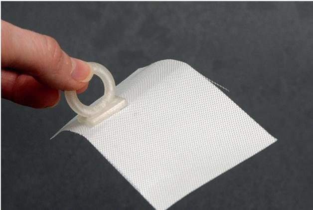
Abb. 1: Nach dem 3D-Druck eines Verbindungsteiles aus PLA auf einem PLA-Gewebe konnte eine gute Haftfähigkeit erreicht werden.
