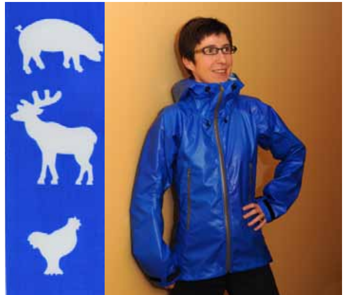
Links : Screen printing van PO dispersie op katoenweefsel Rechts: Regenjas gemaakt uit PO gecoat PES weefsel
