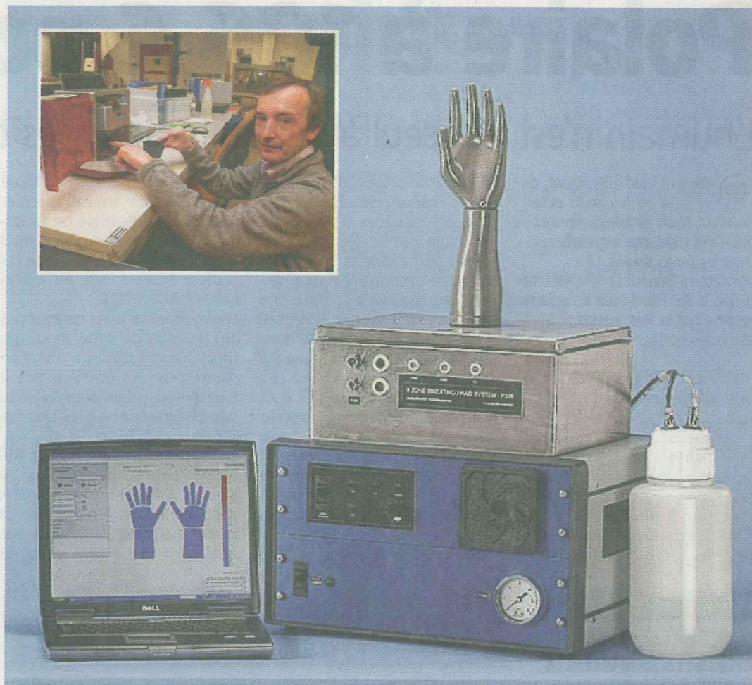
La main destinée à mettre au point les gants high tech. Incrusté : le testeur de gestion d'humidité ■ DR / YB
