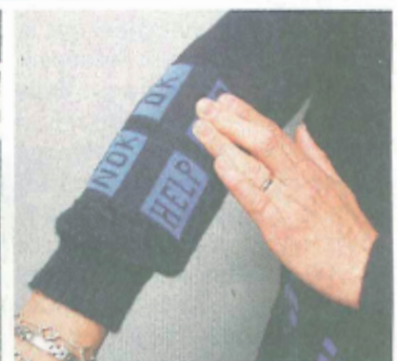
Le pull est doté d'un clavier sur la manche ■ CENTEXBEL/A.DRION
